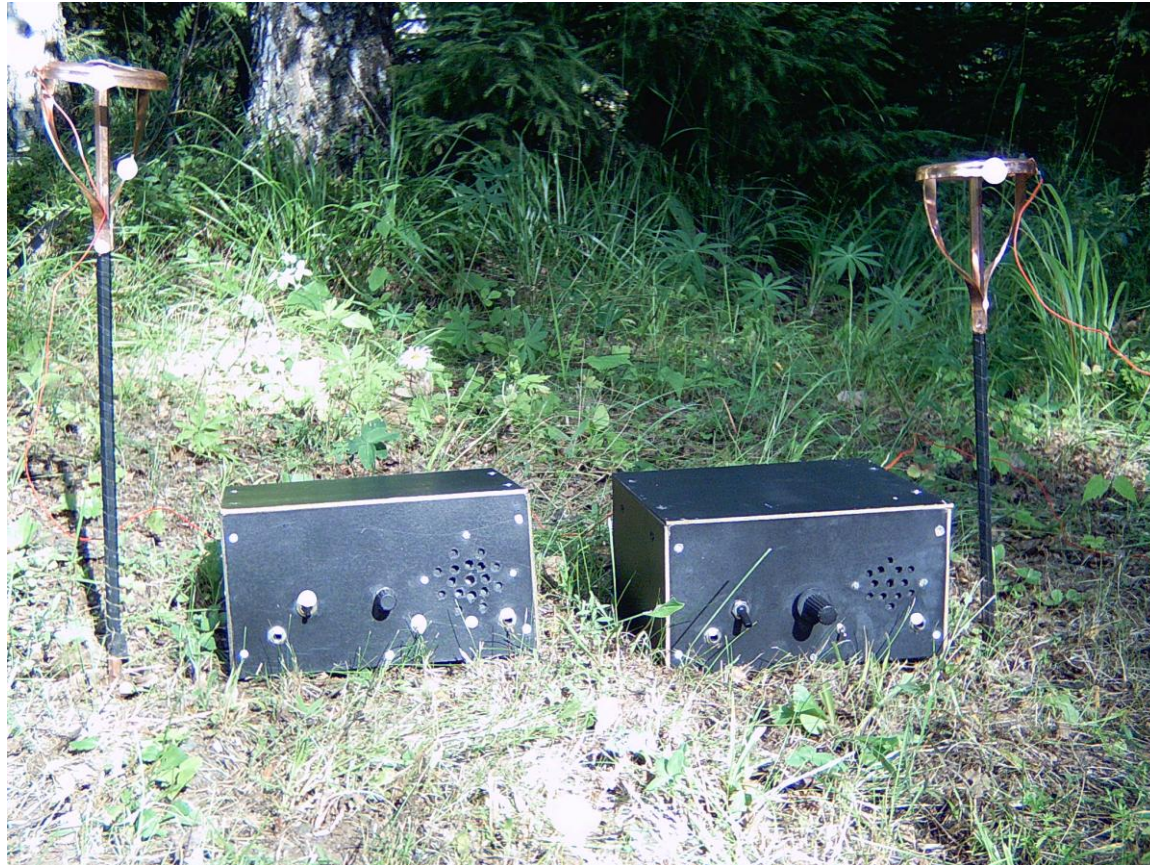
Maasähkötyslaitteet (800Hz) ja maadoitussauvat
