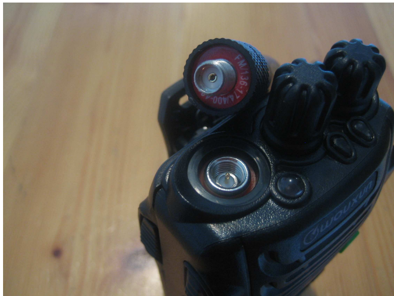
SMA-liitin rigin rungossa ja antennissa. BNC-antenneja varten tarvitaan adapteri.
